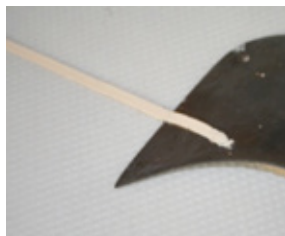
1B. Procédure avec couteau quart de lune sans guide d'arasement.
