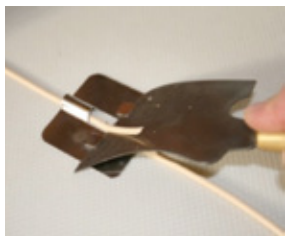
1A. Procédure avec couteau quart de lune avec guide d'arasement
